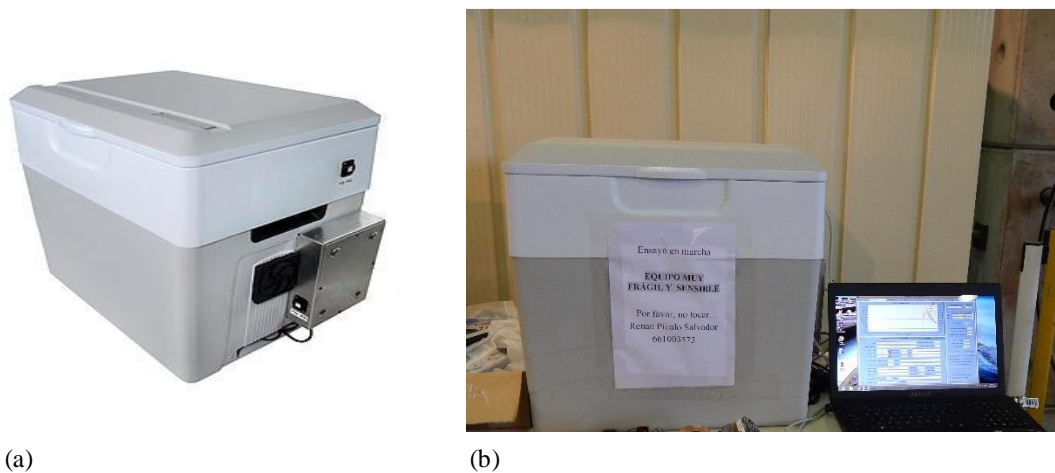
Figura 3.4 (a) Calorímetro iCal-4000 y (b) ubicación del equipo al costado de la cámara climática.
