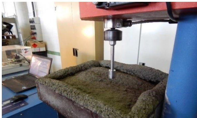
Figura 3.5 Ensayo de resistencia a la penetración
