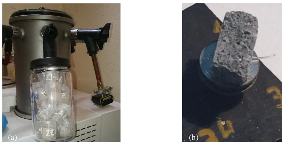
Figura 4.2 Proceso de preparación de las muestras (a) liofilización y (b) cara fracturada con carbón
