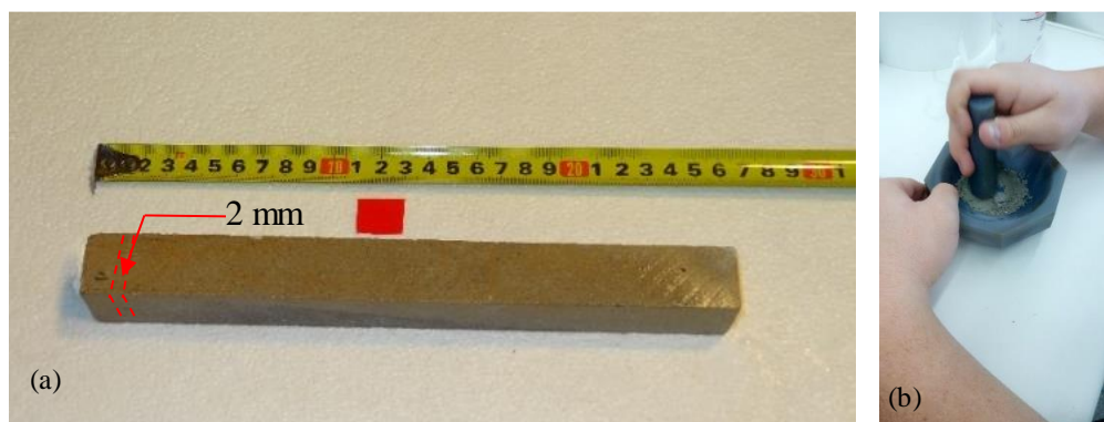
Figura 5.8 (a) Extracción de la muestra de la probeta y (b) proceso de molienda
