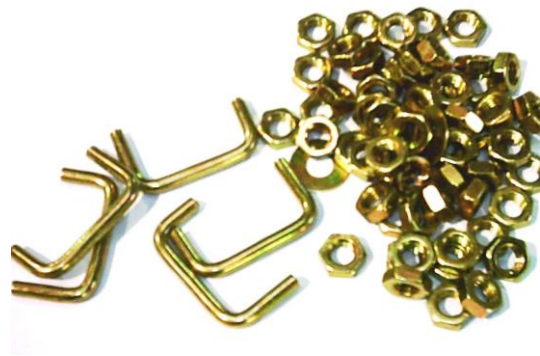
Figura 1.1.4. Acabat d'unes peces metàl·liques que han estat tractades amb un passivat groc
