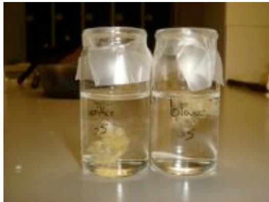
**Figura 2.31: Resultado de la modificación superficial del *biorubber*. La muestra de la izquierda fue modificada con ácido acrílico, el cual, gracias a su grupo carboxílico, tiene una mayor interacción con el agua que el *biorubber* sin modificar. Muestra de ello es el hundimiento de la muestra modificada.**
