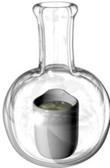
Figura 2.21: Esquema de la situación del molde de *biorubber* dentro del vial que se utilizó para la síntesis por microondas.
