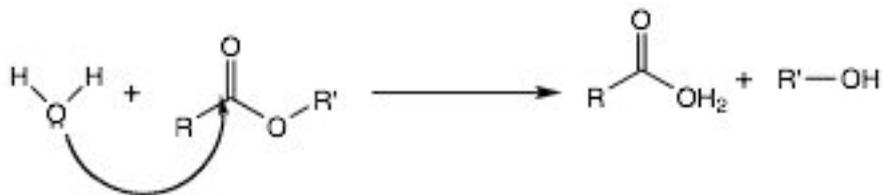
Figura 2.36: Mecanismos de degradación de los poliésteres.
