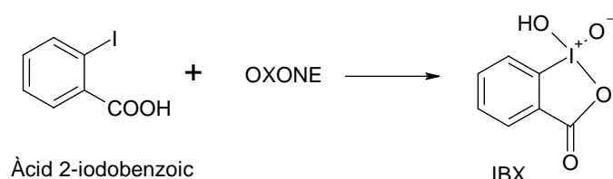
Figura 3.6. Síntesi de l'oxidant IBX (àcid 2-iodoxibenzoic)
