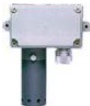
Figura 3.13. Imatge de l'analitzador de NH_3 electroquímic emprat.
