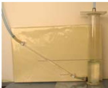
Figura 3.8. Manòmetre inclinat utilitzat en els experiments per determinar la pèrdua de càrrega del biofiltre.
