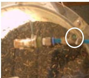
Figura 3.10. Punt de mostreig pels COVs (àrea encerclada) a la sortida del compostador.
