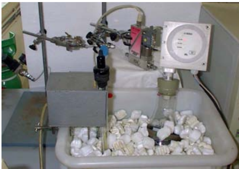
Figura 3.16. Imatge de l'amoniòmetre al laboratori.
