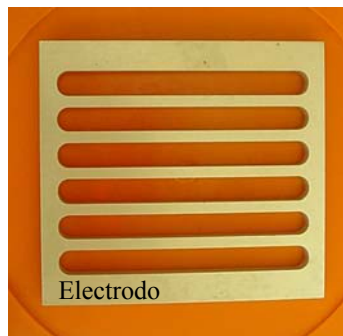
Figura 3.30: Fotografía del electrodo utilizado para la soldadura anódica de las obleas de vidrio y silicio para los diseños mixtos que incluyen una matriz de sensores de gases y la circuitería CMOS asociada.
