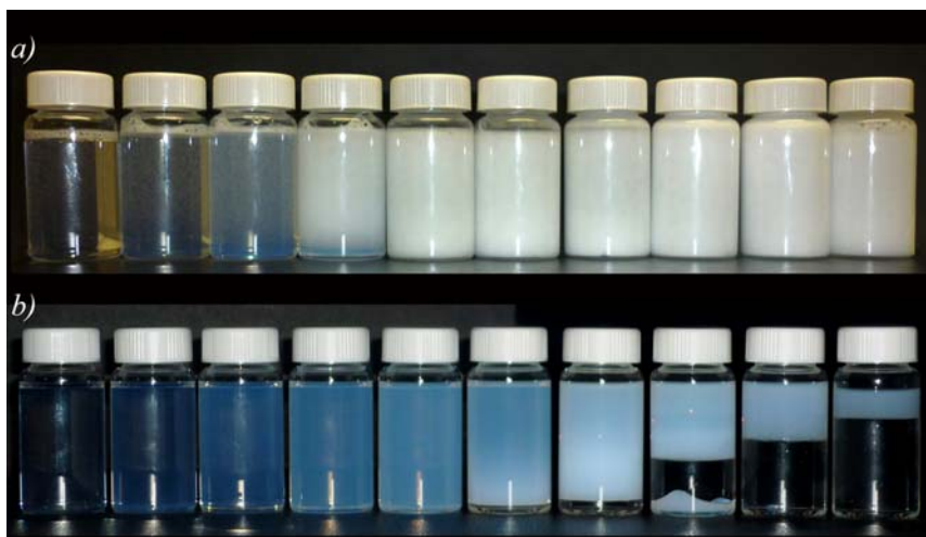
Figura 3.1. Vials preparats per a l'estudi de fases en el moment que van ser preparats (a) i després de restar dues setmanes a l'interior del detector (b).
