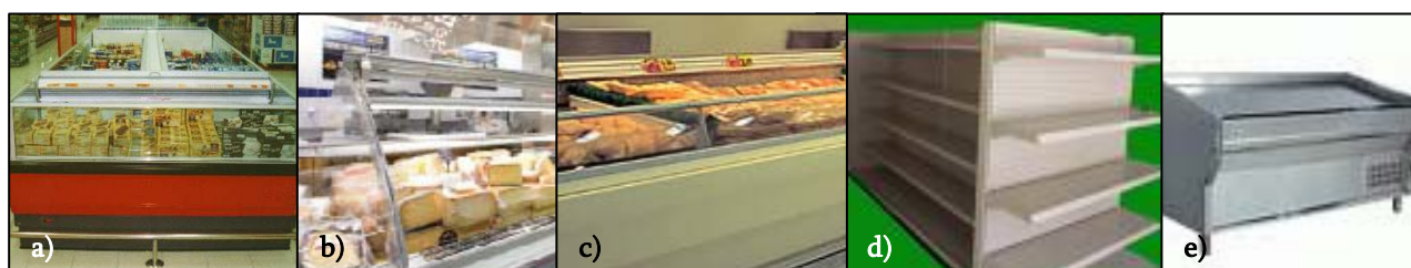
Figura 6. Superficies de trabajo del supermercado. a) arcón congelador, b) vitrina expositora, c) exhibidora refrigerada, d) estantería (góndola) y e) mostrador de pescado.
