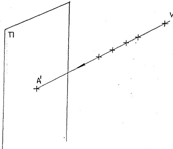
$A'$  es la proyección de infinitos puntos, todos los que se encuentran sobre la dirección que lo une con el punto de vista del observador. En este caso la solución fue determinar una recta sobre la que se apoye el punto y desaparece la indeterminación:
