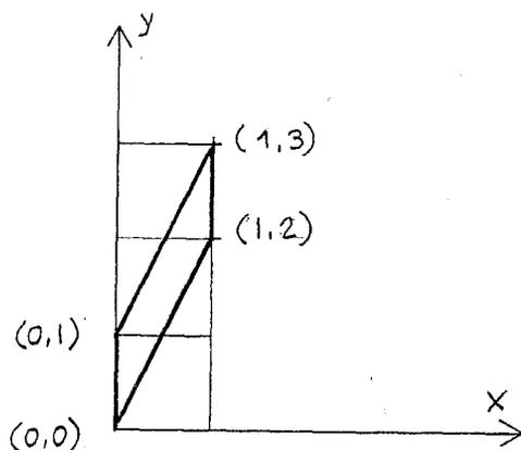
el cuadrado 1-2-3-4, nos ha quedado transformado en el paralelogramo 1'-2'-3'-4', que se obtiene del anterior mediante una cizalladura en la dirección del eje y. Para obtener una cizalladura en la dirección del eje x, basta con mantener A y D, en su valor unitario y dar un valor distinto de cero a C, manteniendo nulo B. Como en el caso de la simetría si B y C son ambos distintos de cero, tendremos el caso general de cizalladura.
