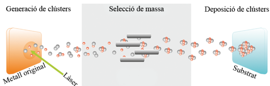
Figura 1.17. Funcionament del mètode "mass-selected soft-landing".
