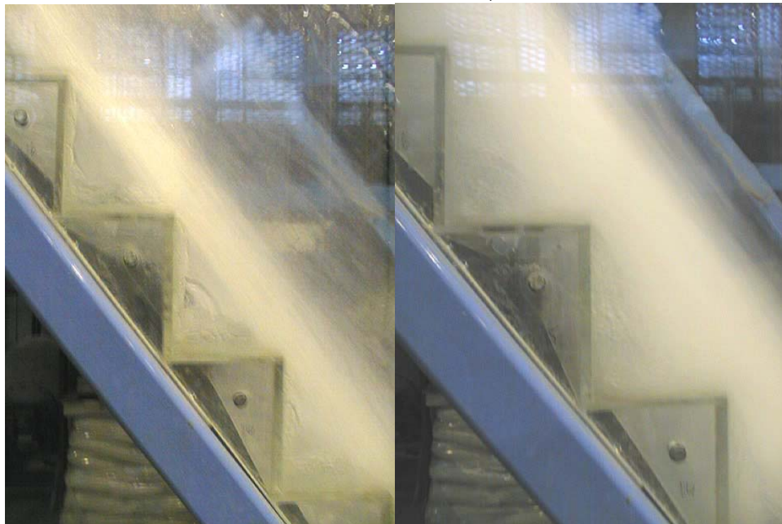
Figura 1.1. Esquema de las categorías de flujo en un vertedero escalonado: a) escalón a escalón y b) rasante.
