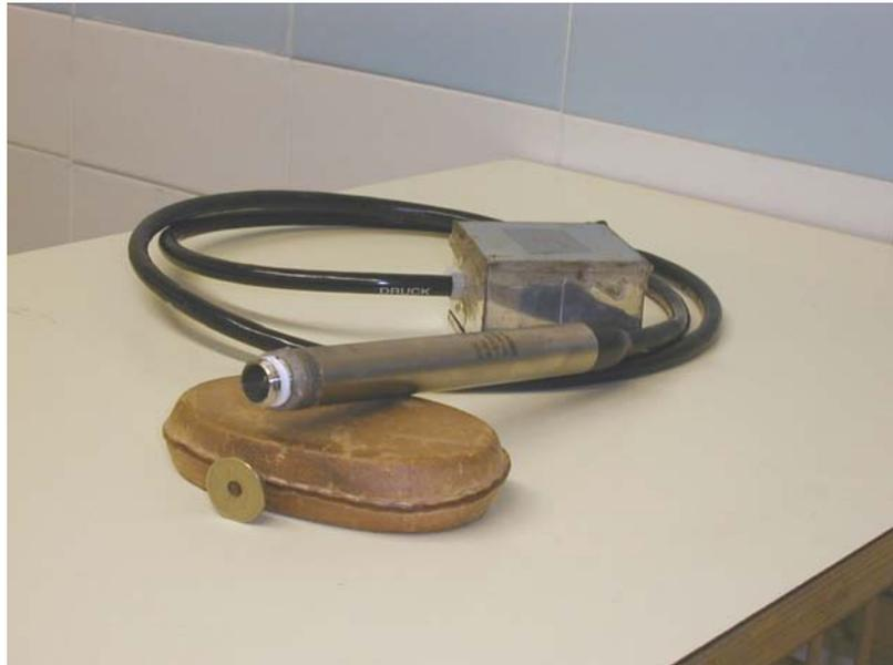
Figura 2.10. Transductor piezorresistivo PTX 1830 utilizados en la campaña de registro de datos en el laboratorio.
