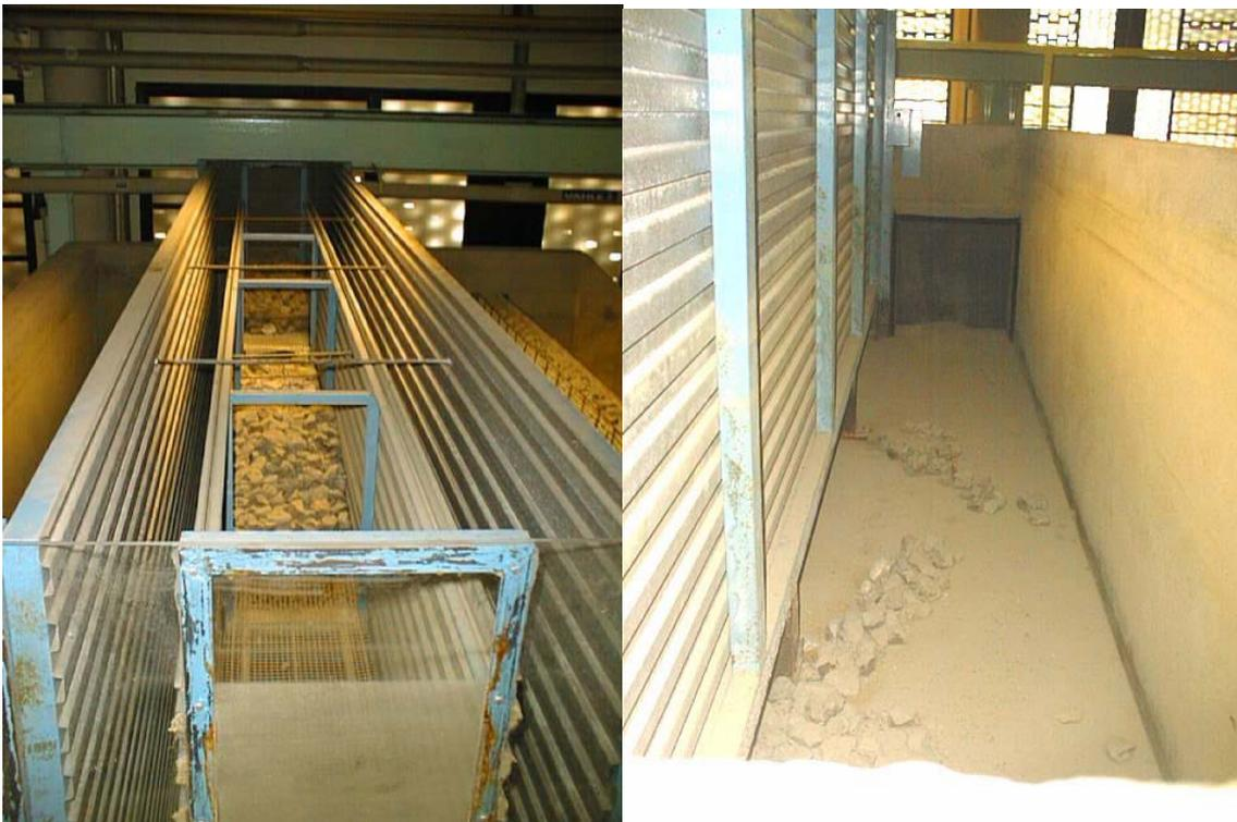
Figura 2.3. Detalles de la entrada del suministro de agua en la estructura soporte del modelo. Detalle del cajón cuadrado de sección  $0.55 \times 0.55 \text{ m}^2$  por el que entra el agua al canal de aproximación a la rápida.
