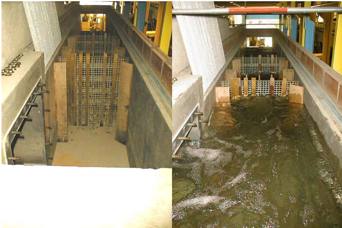
Figura 3.21. Imagen en seco y en funcionamiento de los elementos homogeneizadores del flujo en el canal de aproximación.
