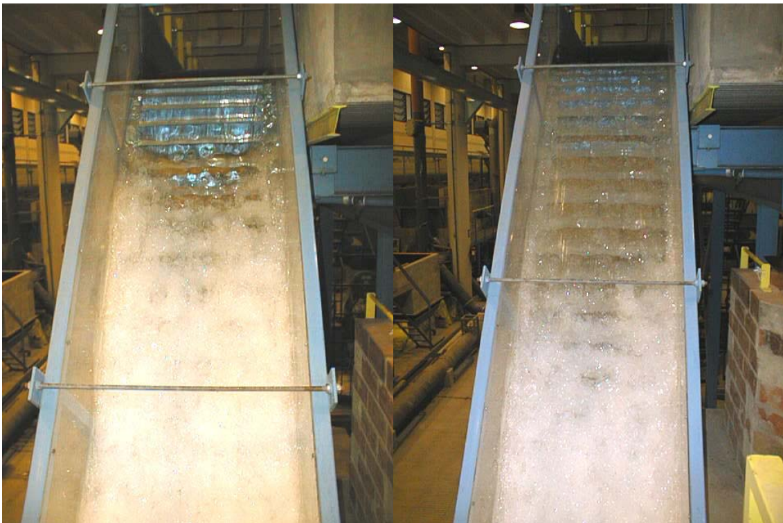
Figura 4.4. Detalles de la zona de entrada de aire en el modelo del Laboratorio de Mecánica de Fluidos de la UPC.
