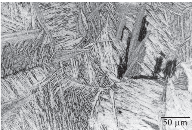
Figura 1.8 Microestructura Widmanstätten del titanio cp de grado tres.
