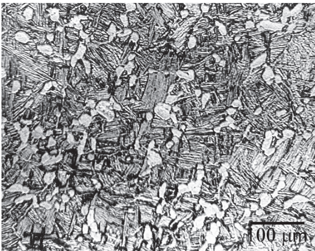
Figura 1.10 Microestructura dúplex del Ti6Al4V.
