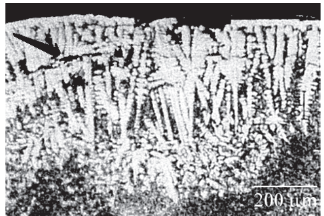
Figura 1.19 Capa de nitruros de titanio obtenida por ablación láser, con presencia de grietas subsuperficiales.
