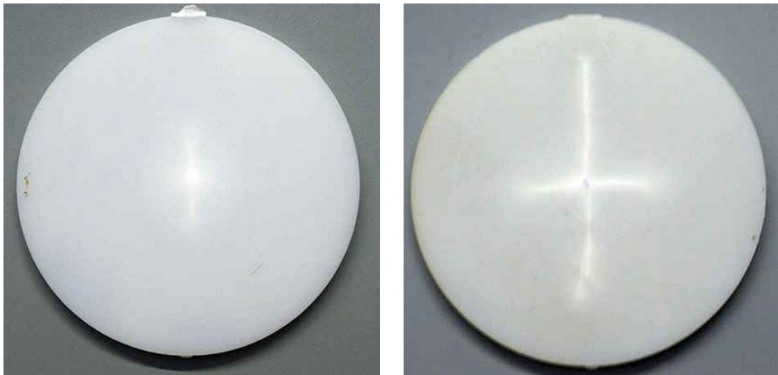
Figura 5.13 Daño ocasionado por el impacto sobre discos de HIPS a 2 diferentes alturas de caída.
