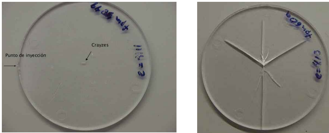
Figura 5.12 Daños sobre discos de poliestireno sometidos a flexión en impacto. Izquierda: aparición de crayzes; derecha: propagación de grietas
