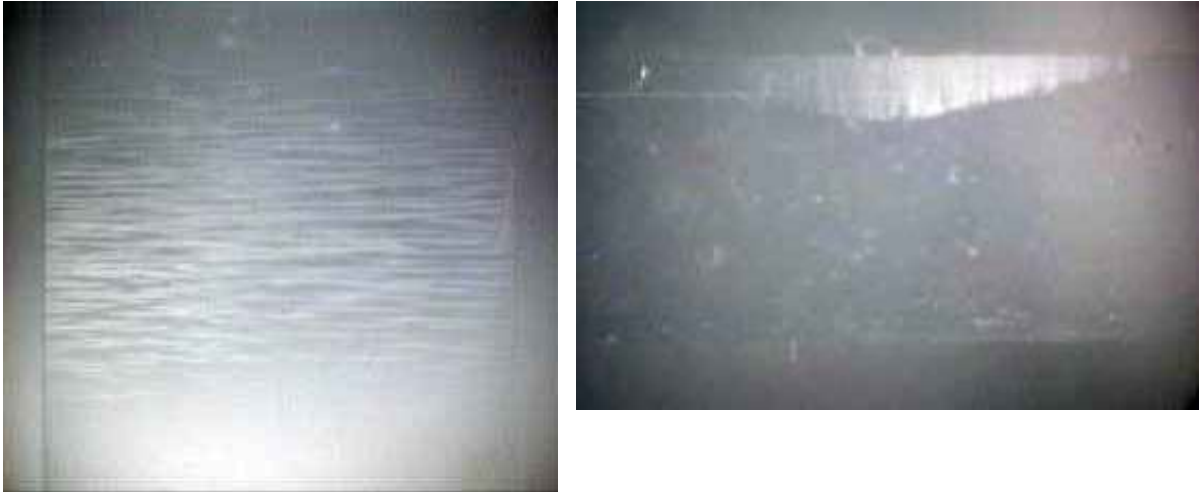
Figura 5.18 Crazes ocasionadas por el impacto sobre una barra prismática de PS.
