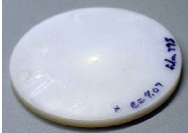
Figura 5.14 Huella dejada por la indentación ocasionada por el impacto (en flexión) sobre un disco de 50%PS+50%HIPS
