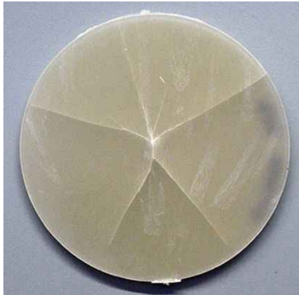
Figura 5.15 Daños de una probeta de PS-mev sometida a impacto
