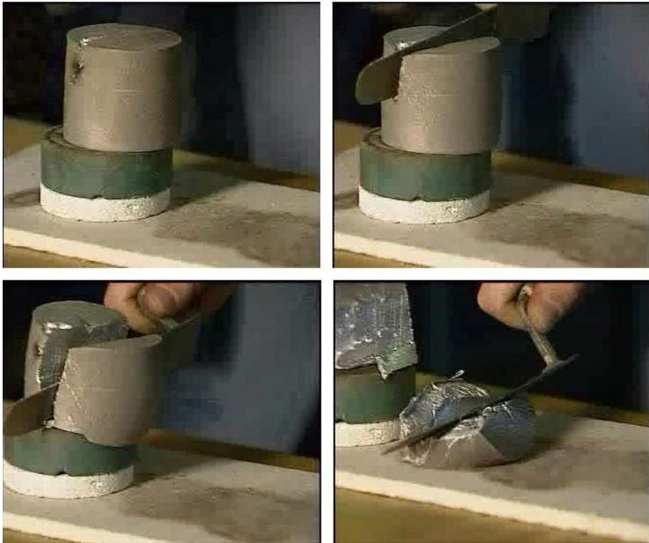
Figura 1.1. Corte de un lingote de Rheocasting [Jor02].
