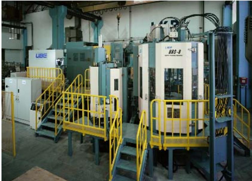
**Figura 1.23.** Máquina de New Rheocasting UBE HVSC PL-800 NRC en el laboratorio de LKR [Wabu00].
