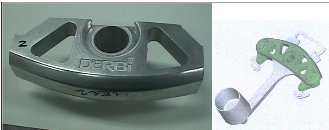
Figura 4.4. Pletina de dirección motocicleta de 50 cc (Derbi).
