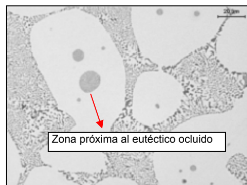
Figura 5.78. Microestructura del lingote de Rheocasting recalentado, mostrando zonas de ensayo de ultramicrodureza en una dendrita \alpha .
