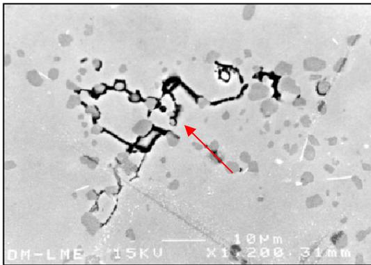
**Figura 6.54.** Micrografía SEM A357 T6 donde se aprecia una grieta siguiendo al silicio.
