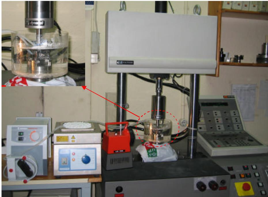
**Figura 2.7.** Montaje para los ensayos de contacto Hertziano sobre el recubrimiento bicapa (6P64/6P53B+5HA) en presencia de SBF.
