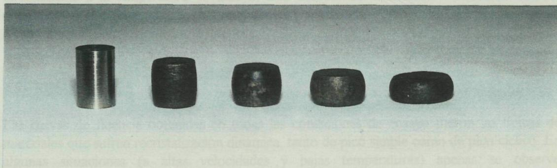
Figura 7.5. Probetas utilizadas en los ensayos de compresión. Se muestra una secuencia de deformaciones verdaderas de 0, 0.25, 0.5, 0.75 y 1.
