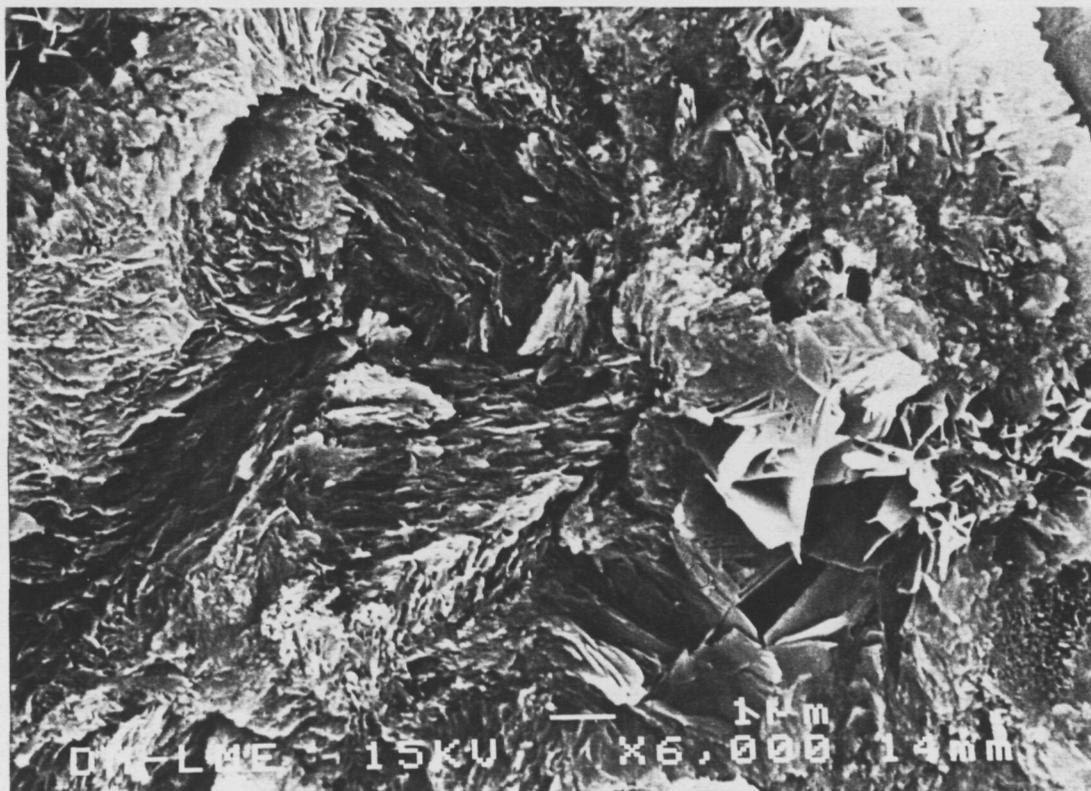
Figura 5.8 i).- Microestructura observada en el cemento H-g después de 360 h de reacción
