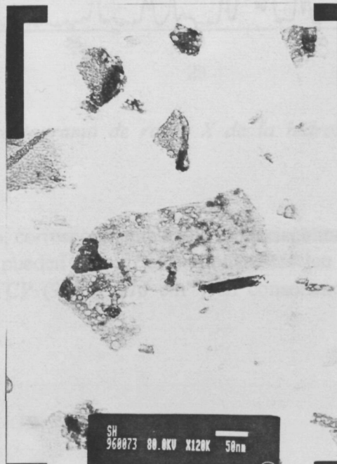
Figura 6.6.- Micrografía obtenida mediante microscopía electrónica de transmisión del polvo de hidroxiapatita precipitada elaborado a partir del fraguado del cemento H (PHA-H).
