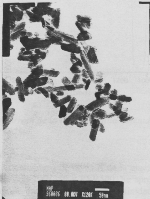
Figura 6.11.- Micrografía obtenida mediante microscopía electrónica de transmisión de la nanoapatita sometida a un tratamiento hidrotérmico (NA).
