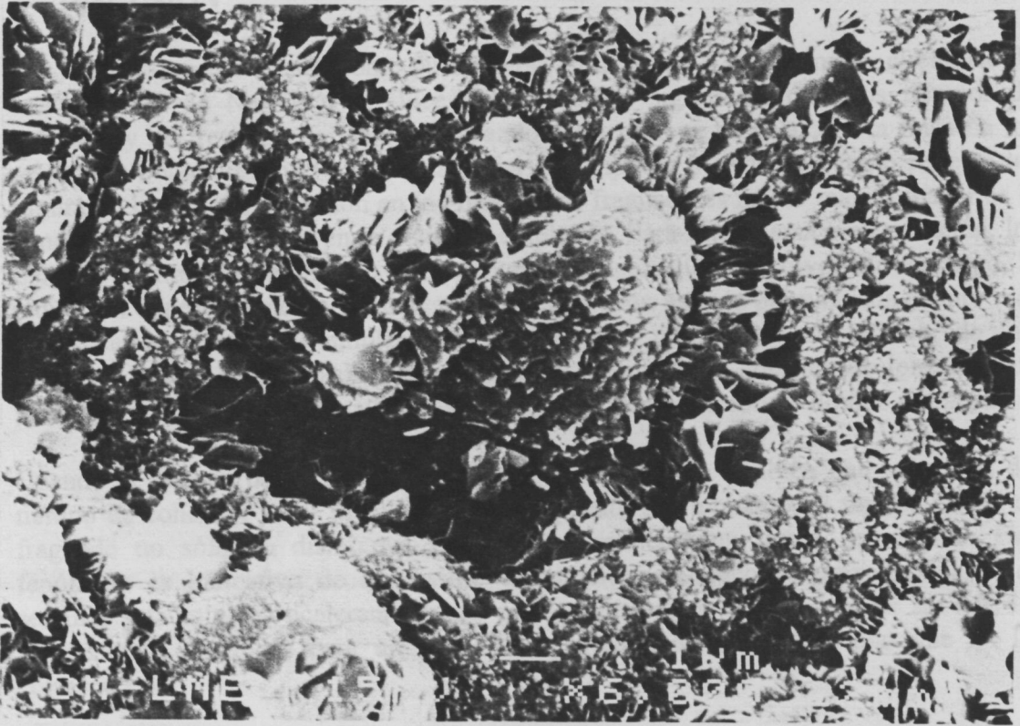
Figura 7.11 f).- Microestructura del cemento formado por \alpha -TCP con un 2% de PHA y agua bidestilada después de 64 h de reacción.
