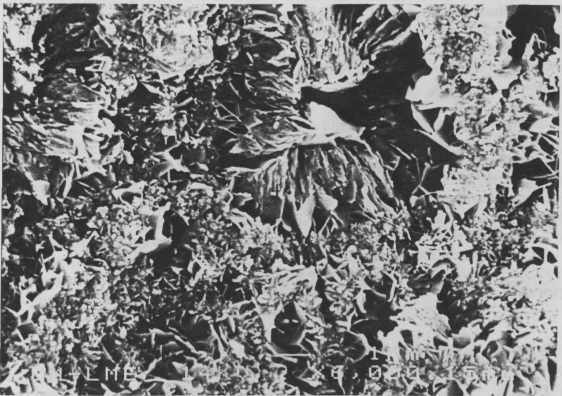
Figura 7.11 g).- Microestructura del cemento formado por \alpha -TCP con un 2% de PHA y agua bidestilada después de 360 h de reacción.
