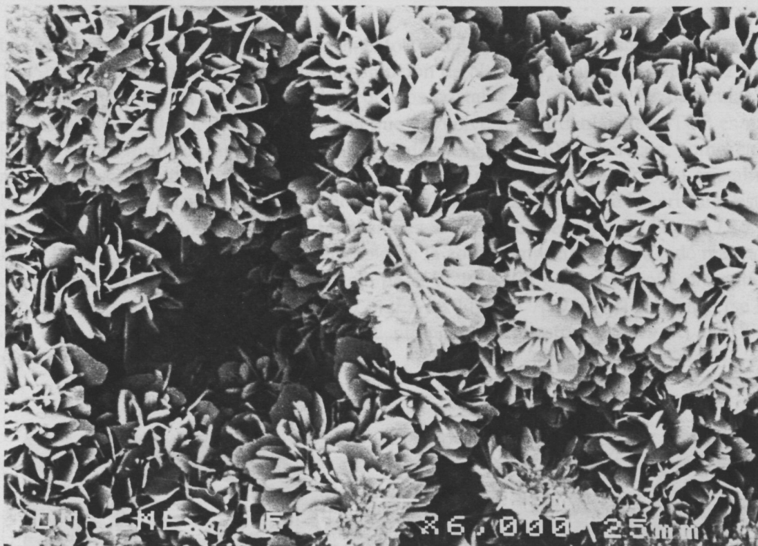
Figura 7.9 h).- Microestructura del cemento formado por \alpha -TCP y agua bidestilada después de 360 h de reacción
