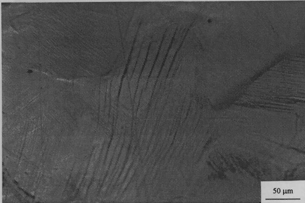
Figura 3.27. Placas de martensita que atraviesan los límites de grano.
