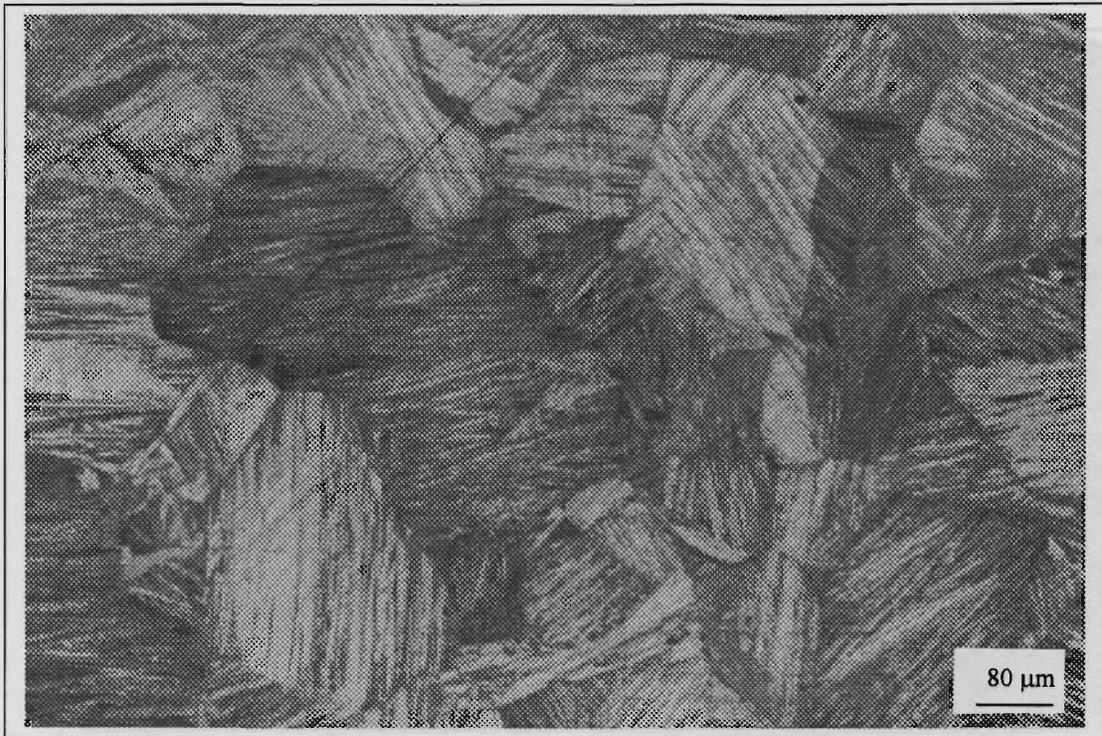
Figura 2.5. Microestructura obtenida para las aleaciones en fase martensita.
