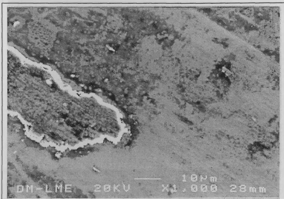
Figura 4.71. Detalle de la Figura 4.70 en la que se observa una partícula adherida a la superficie.
