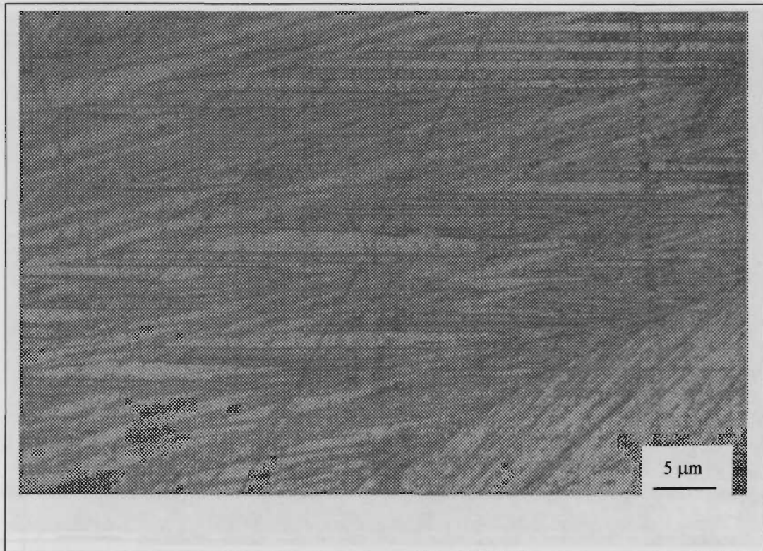
Figura. 4.50. Detalle de la Figura anterior en la que se observa la morfología de las placas de martensita interiores a la superficie sin ninguna orientación preferencial.
