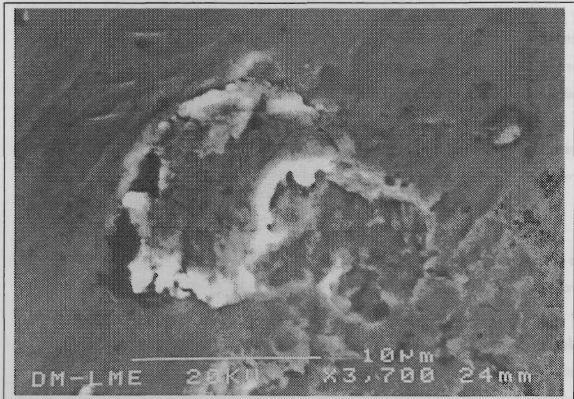
Figura 4.67. Detalle de la Figura 4.55 en la que además de observar las partículas adheridas en la superficie del pin se observa también deformación plástica alrededor de esta partícula. Es esta deformación una causa del mecanismo de desgaste-fatiga.
