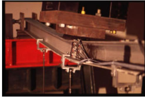
Figura 4-17. Pandeo lateral de la viga biapoyada H 100x100.
