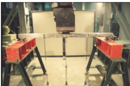
**Figura 4-6. Vista de la viga de acero inoxidable SHS 80x80-1.**
