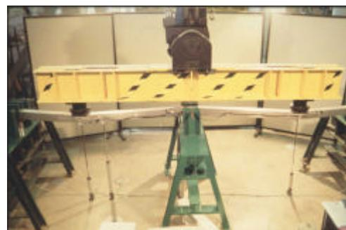
**Figura 4-7. Vista de la viga de acero inoxidable SHS 80x80c-1.**
