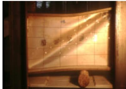
**Figura 7-30. Deformada numérica y experimental de la viga ad2w4 al final del proceso de carga.**
