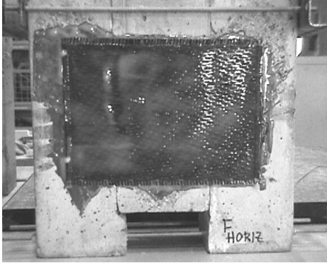
Figura 5.13 Probeta TRI-Unión Horizontal con el eje principal de las fibras orientadas horizontalmente y las galgas orientadas en la misma dirección.
