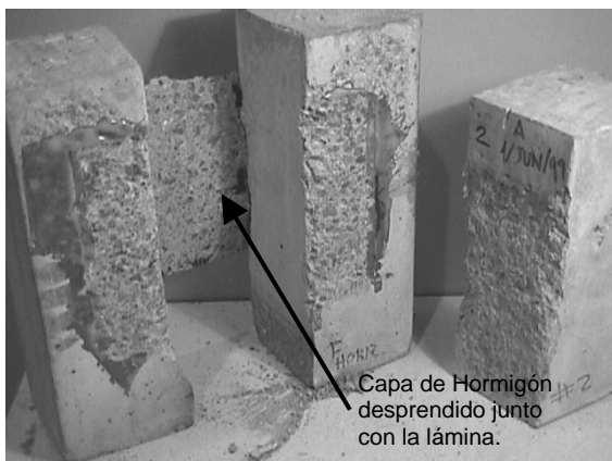
Fig. B71 Esta foto muestra la cara de los bloques laterales del lado "B" y la cara del bloque central del lado "A" de la probeta.
