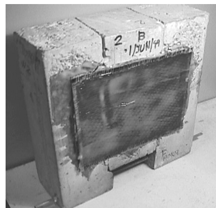
Fig. B70 La galga que registra las deformaciones horizontales fue colocada en la zona de unión entre bloques entre el mismo par de bloques unidos, solo que del lado opuesto.
