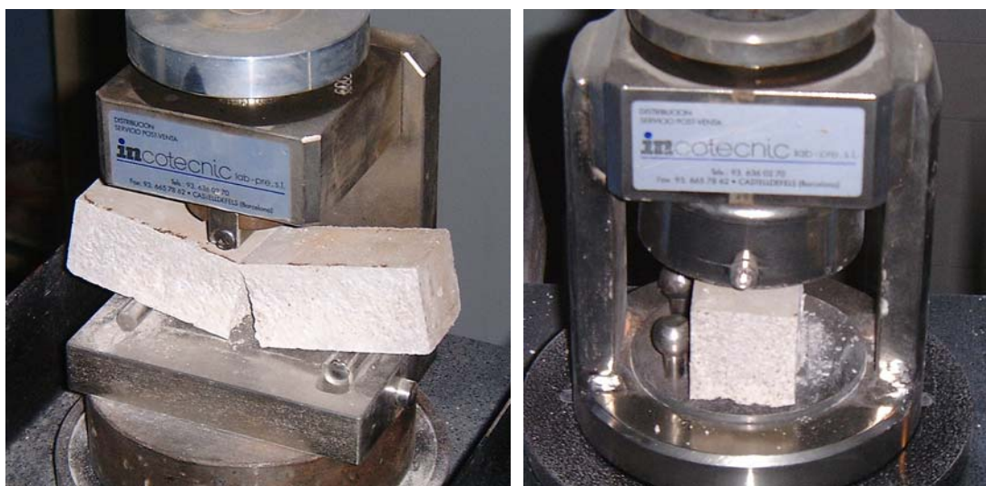
Figura II.1 — Ensayos de flexotracción y compresión conforme a UNE-EN 196-1, para la campaña experimental de rotura de probetas reforzadas con GFRP, AFRP y otros materiales. Laboratorio de Tecnología de Estructuras, UPC
