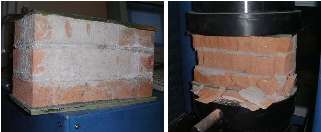
Figura II.2 — Ensayos de rotura de tripletas de ladrillo: (a) tripleta refrentada antes de rotura; (b) muestra después de la rotura
