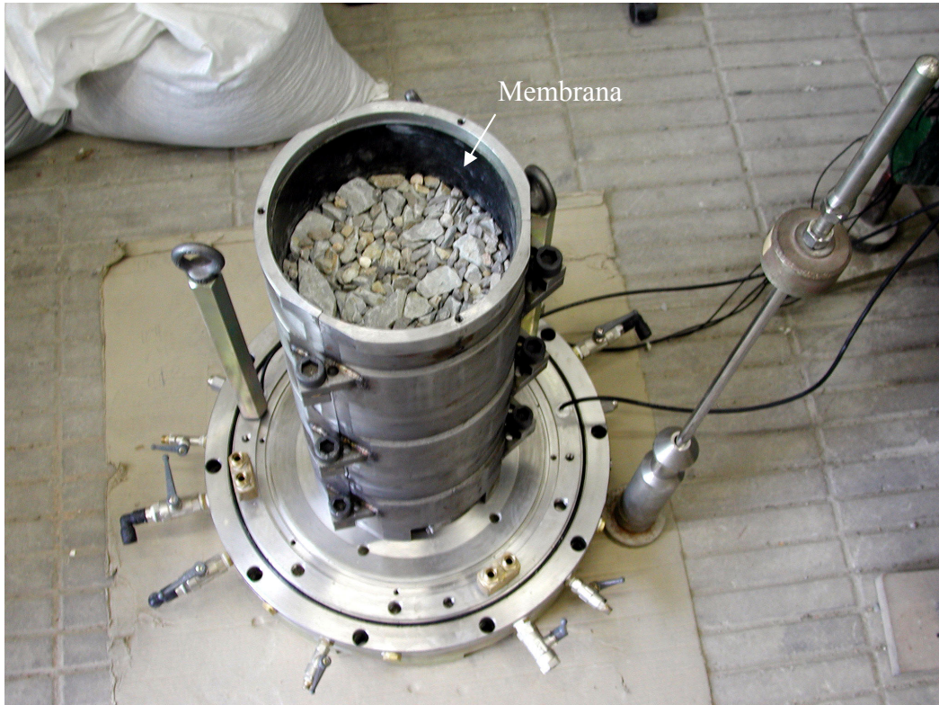
Figura 3.6 Molde de compactación colocado sobre la base del triaxial.
