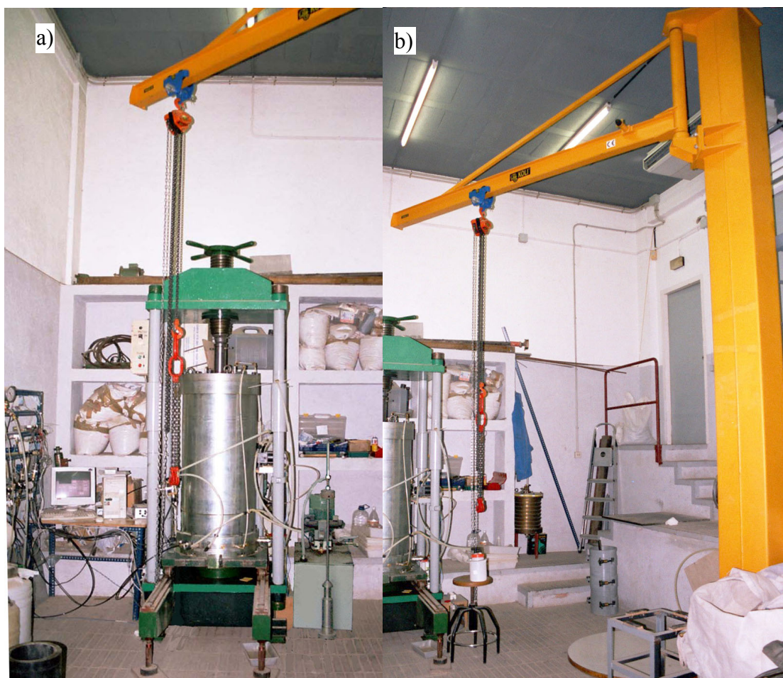
Figura 3.1 Fotografía del equipo triaxial de escolleras. a) Célula triaxial, b) Grúa para la manipulación del equipo.
