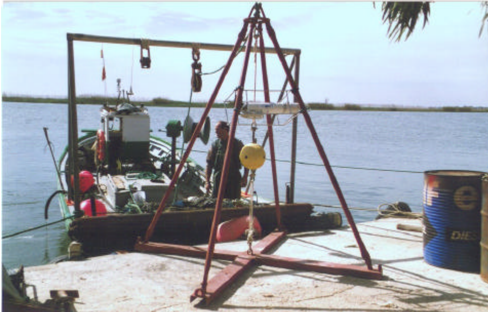
Figura 5.3.- Tetrápodo con el sistema PUV fondeado 3.5 m.
