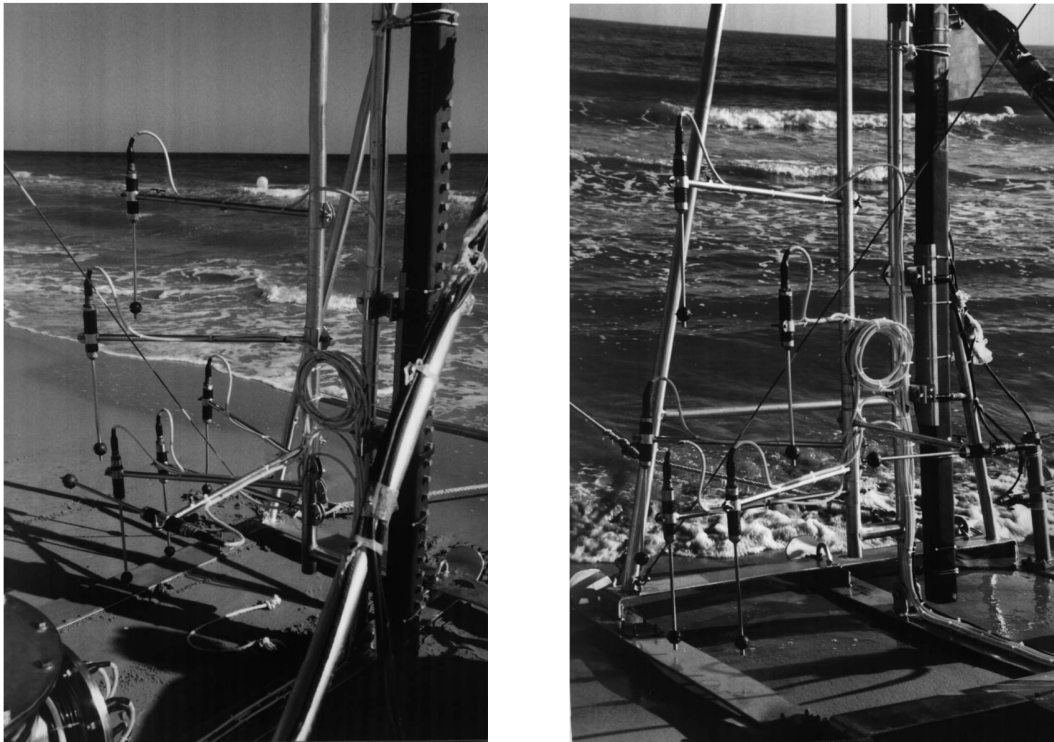
Figura 5.7.- Disposición vertical de los correntímetros electromagnéticos colocados en el trineo.
