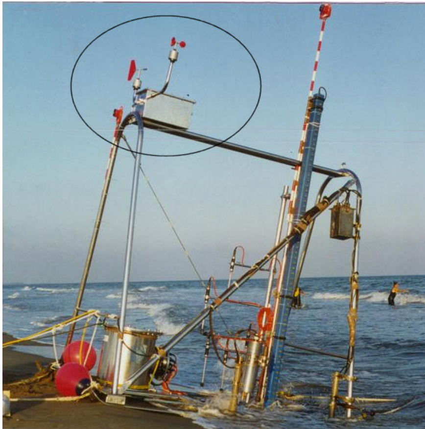
Figura 5.6.- Estación meteorológica colocada en el Trineo.
