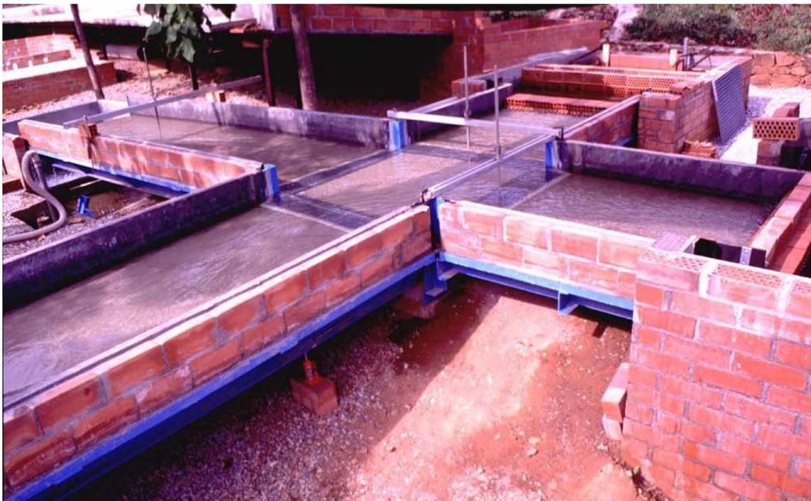
Figura 5-9: Fotografía del dispositivo experimental construido en el laboratorio de modelos reducidos de la Universitat Politècnica de Catalunya.
