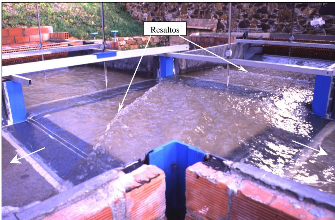
Figura 6-5: Ejemplo de patrón de flujo Tipo II.  $Q_{ex} = 100,1$  l/s;  $Q_{ey} = 25,0$  l/s;  $Q_{sx} = 97,2$  l/s;  $Q_{sy} = 27,8$  l/s;  $F_{ex} = 2,08$ ;  $F_{ey} = 0,18$ ;  $W_x/W_T = 0,859$ ;  $\alpha_x = 34^\circ$ .
