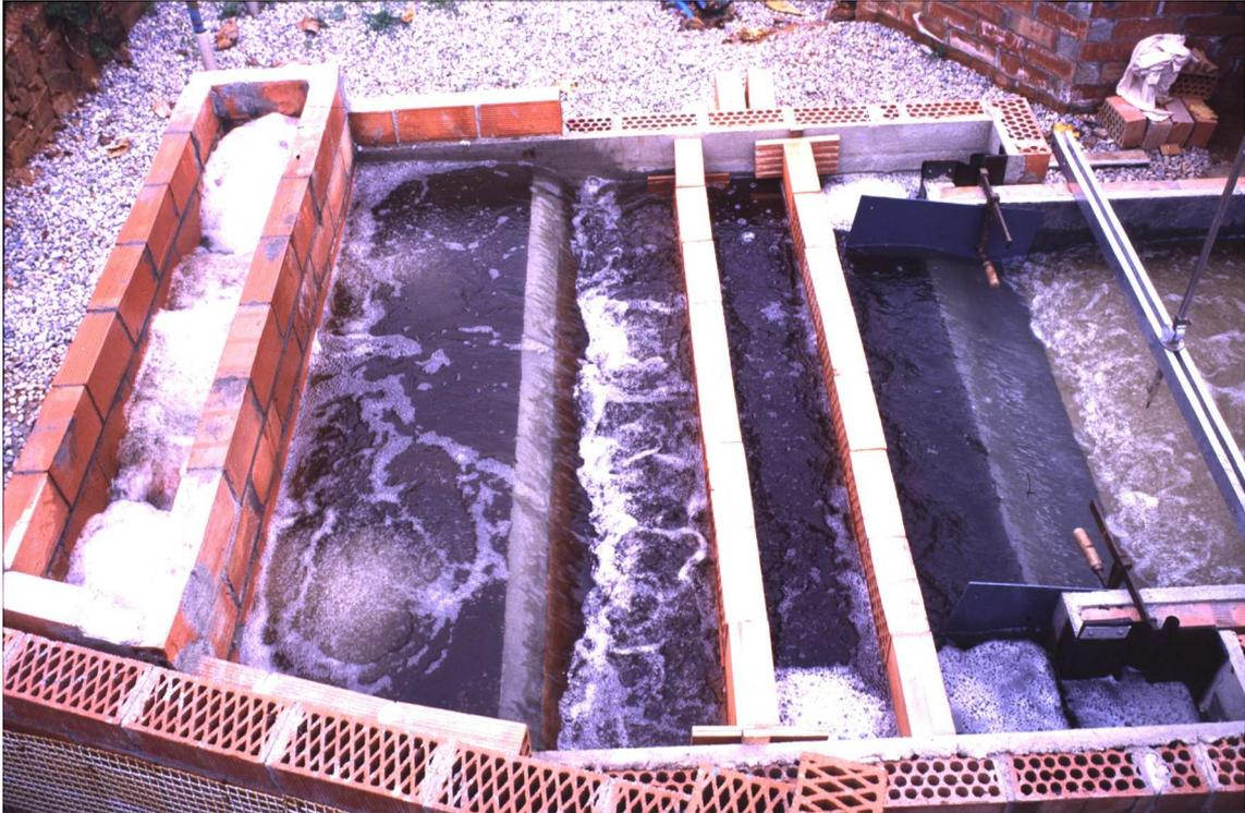
Figura 5-11: Arqueta de entrada en la dirección "x".  $Q_{ex} = 99,8$  l/s.
