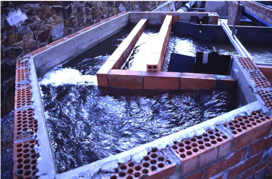
Figura 5-12: Arqueta de entrada en la dirección "y".  $Q_{ey} = 50,2$  l/s.
