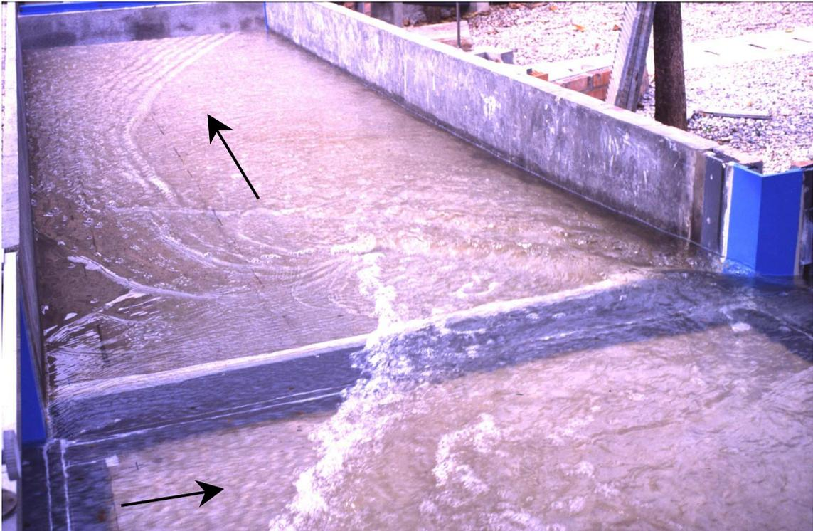
Figura 6-8: Zona de separación en la calle de salida en la dirección "x".  $Q_{ex} = 25,1$  l/s;  $Q_{ey} = 25,0$  l/s;  $Q_{sx} = 24,4$  l/s;  $Q_{sy} = 25,7$  l/s;  $F_{ex} = 0,41$ ;  $F_{ey} = 3,39$ ;  $W_x/W_T = 0,398$ ;  $\alpha_y = 25^\circ$ .
