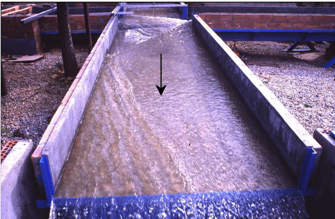
Figura 6-9: Ondas cruzadas en las calles de salida en la dirección "y".  $Q_{ex} = 43,2$  l/s;  $Q_{ey} = 100,2$  l/s;  $Q_{sx} = 38,5$  l/s;  $Q_{sy} = 104,9$  l/s;  $F_{ex} = 0,26$ ;  $F_{ey} = 2,68$ ;  $W_x/W_T = 0,208$ ;  $\alpha_y = 27^\circ$ .
