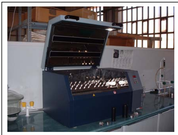
Figura 2-2. Reactor individual oscil·lant Easydye de Datacolor
