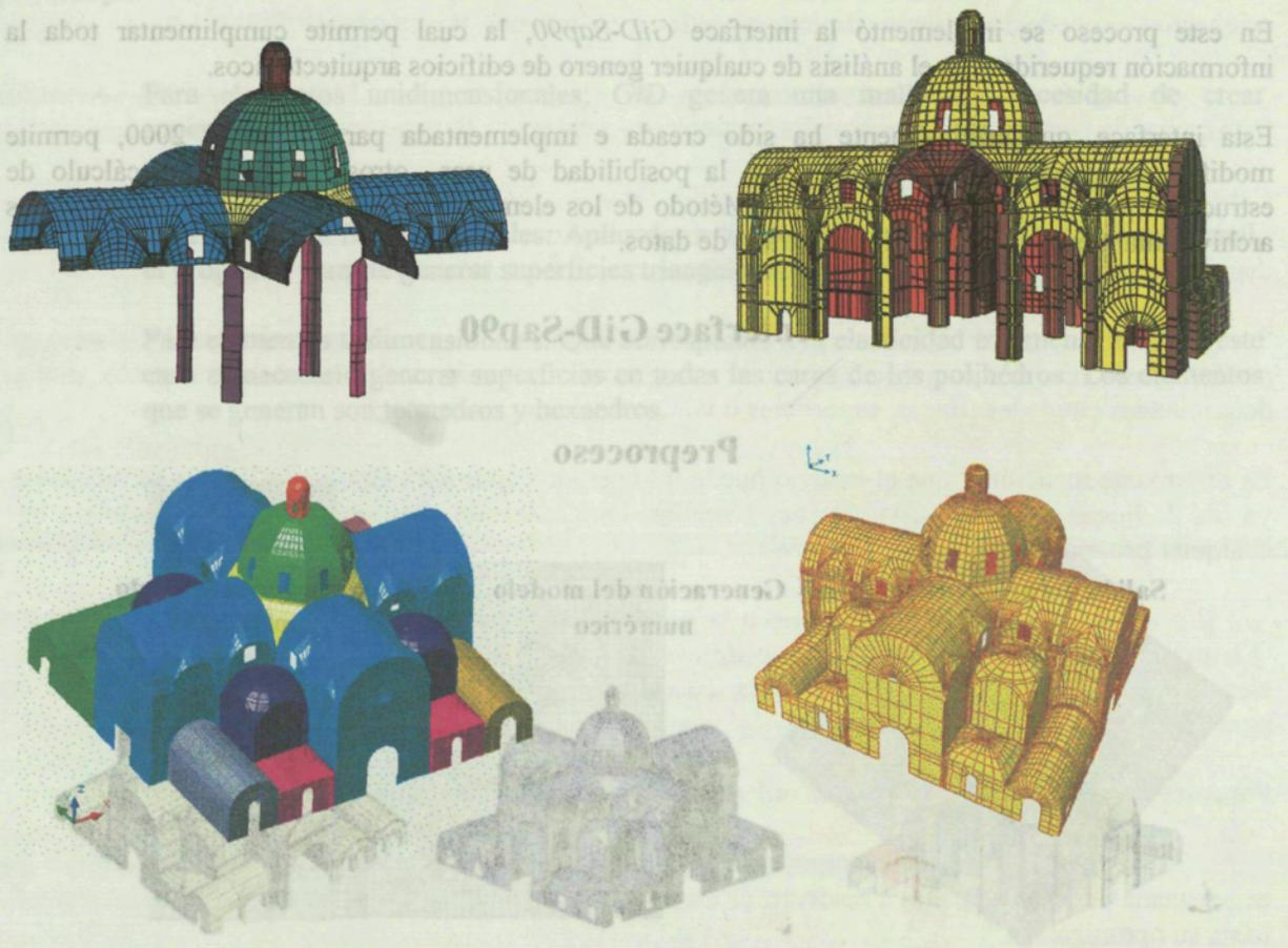
Fig. 6.1.6 Proceso de la generación geométrica del sagrario
