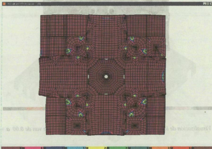
Fig. 7.1.8 Visualización de los esfuerzos F11 con valores parametrizados que van de 0.00 a +4.00 1/m
