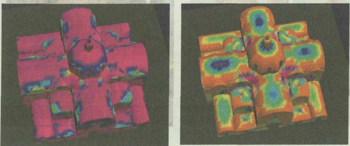
Fig. 7.1.18 Visualización de los esfuerzos  $F_{22}$  positivos y negativos mediante la interface Sap2000-VRML
