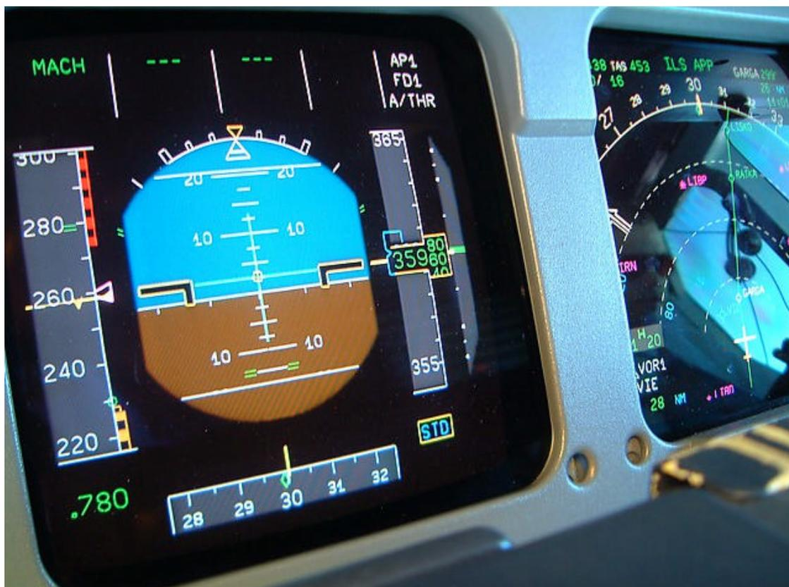
Figura 16. Airbus A-320: a la izquierda, Primary Flight Display; a la derecha, Navigation Display
