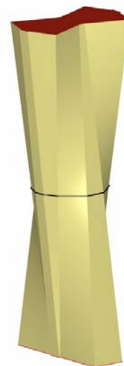
La separación entre armaduras longitudinales es mínima en la sección central. El pilar presenta una especie de garganta.
