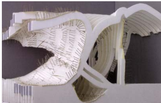
Fig. 22: Render interior y estudio del sistema estructural y constructivo. Se utiliza, como en la mayoría de los proyectos de NOX, un sistema de costillas. Su diseño se estudia mediante maquetas. Las primeras se hacen con papel, después se pasa a la madera. Los datos que se obtienen se introducen en el ordenador y a partir de ahí se desarrolla el proyecto. Soft Office (2001).
