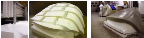
Fig. 12: Evolución digital, despiece, sistema de corte y construcción de las piezas y render final. D-tower (2004).
