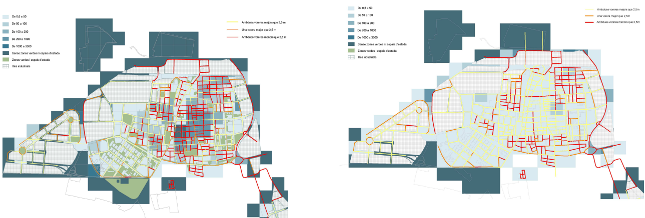
Fig. 8.4.3.2. Distribución de calles con dos aceras con a menor a 2,5 m. Antes y Después.
