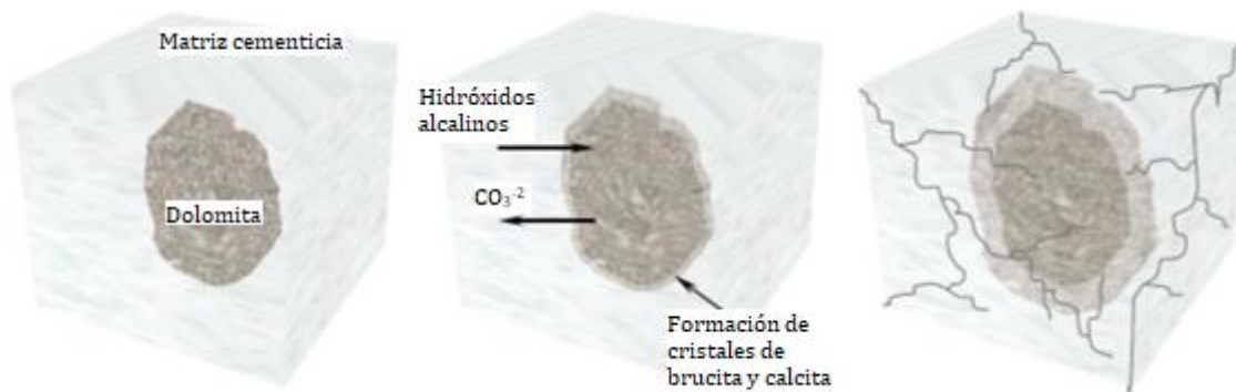
Figura 2.1 - Etapas de la reacción álcali-carbonato (Couto, 2008).
