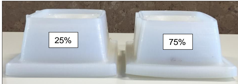
Figura C.4. Alabeo producido por las contracciones del material según el porcentaje de relleno. Fuente: Nexeo 3D.
