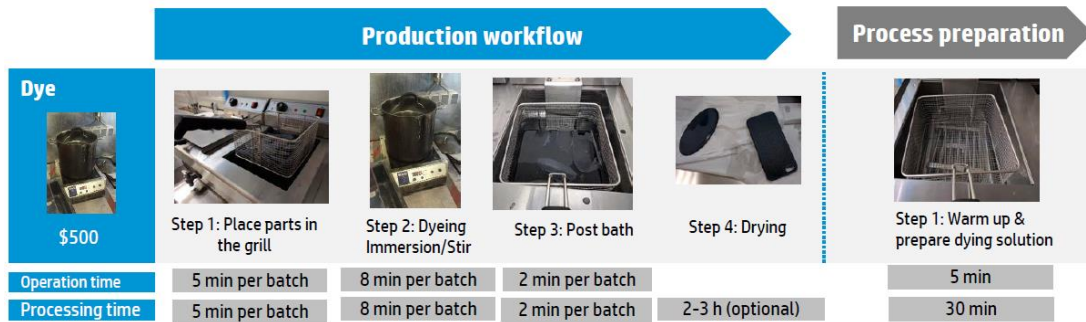
Figura 3.6. Flujo de trabajo de la infiltración de color. Fuente: [100].
