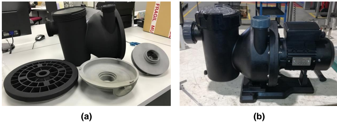
Figura F.2. (a) Piezas impresas y pintadas. (b) Ensamblaje total de la bomba hidráulica. Fuente: Propia.
