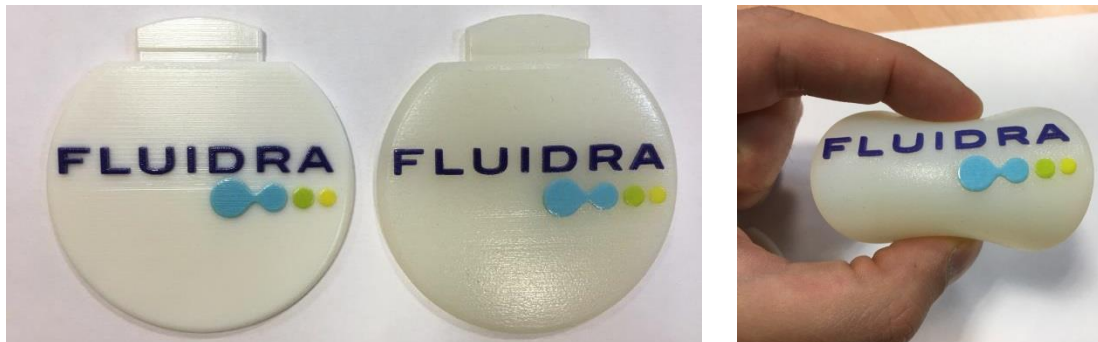
Figura E.3. Personalización de la tapa mediante PJ. Fuente: Propia.
