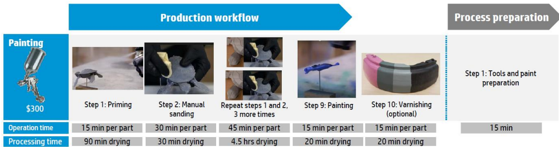
Figura 3.7. Flujo de trabajo en el proceso de pintado. Fuente: [100].
