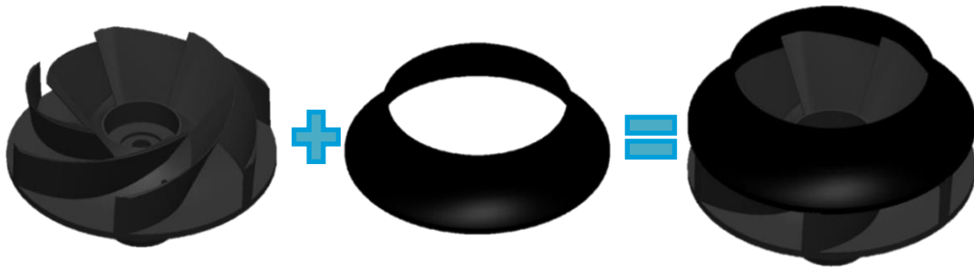
Figura F.3. Proceso de fabricación de los rodetes de bomba. Fuente: Propia.
