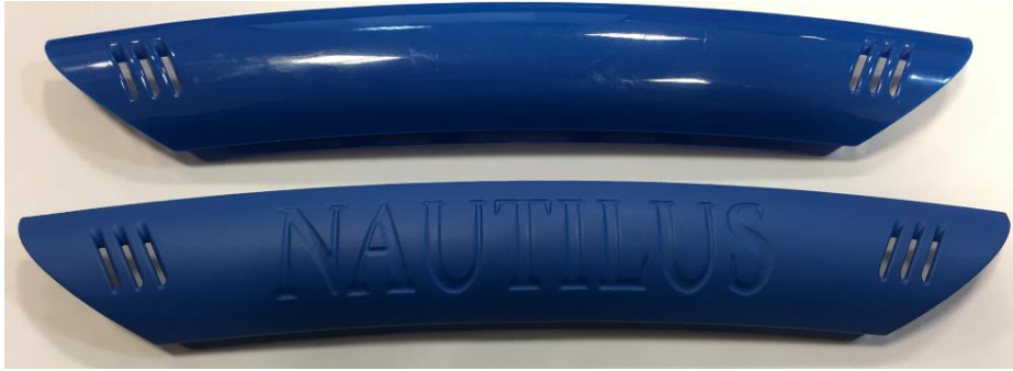
Figura E.4. Embellecedor inyectado (superior) y personalización (inferior). Fuente: Propia.
