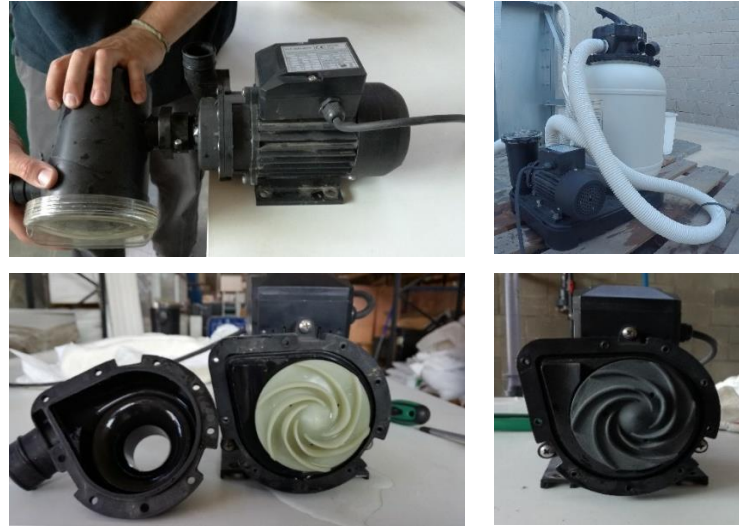
Figura 6.3. Montaje y desmontaje de la bomba hidráulica. Fuente: Propia.
