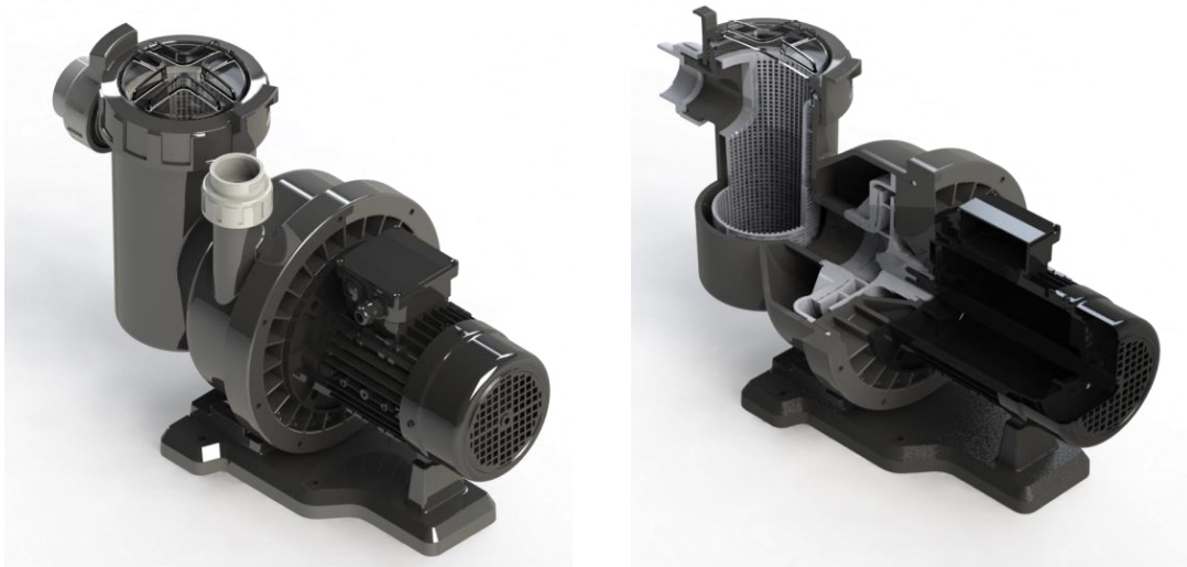
Figura F.1. Propuesta de diseño para una bomba hidráulica de 1 CV. Fuente: Propia.
