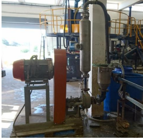
Figura 4.3 Bomba centrífuga Warman, amb motor WEG de 30kW de potència nominal, i cabalímetre Endress+Hauser, model Promass 83F I. Al costat dret, dipòsit d'entrada al circuit.
