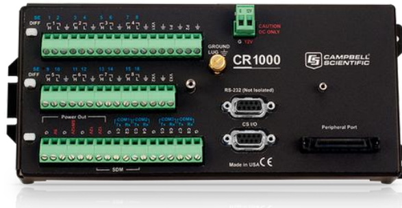
Figura 3.47 Enregistrador de dades Campbell, model CR1000, encarregat del registre de les lectures dels sensors instal·lats al llarg del circuit.
