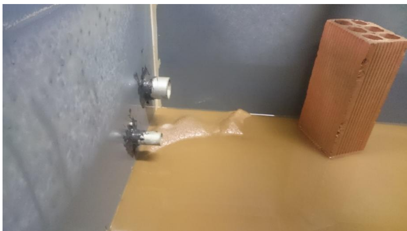
Figura 3.68 Acumulació de sediments a l'interior del Dipòsit 2, en la zona més propera a la connexió del dipòsit amb les canonades. Imatge posterior als assajos duts a terme amb la mescla S1.
