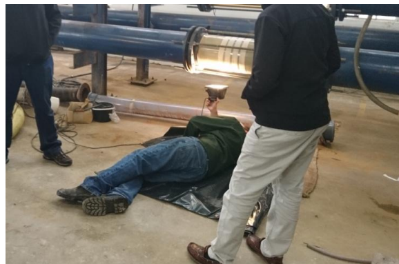
Figura 4.12 Exemple de com es duu a terme la determinació de la velocitat límit de deposició, en un tram de canonada transparent amb l'ajuda d'un focus.
