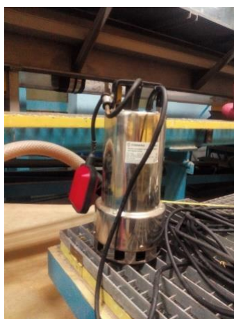
Figura 3.42 Bomba centrífuga submergible Sterwins, model 1000 DW-3, a l'esquerra. A la dreta, punts de la seva corba característica proporcionats pel fabricant.
