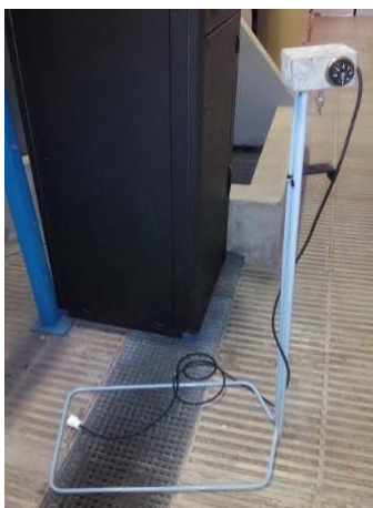
Figura 3.43 Resistència elèctrica utilitzada per escalfar el líquid assajat.
