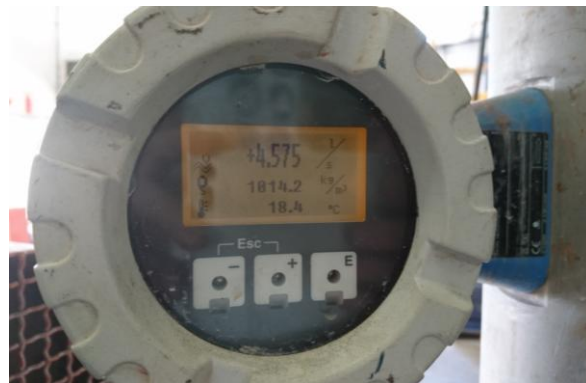
Figura 4.5 Pantalla de visualització del cabalímetre, amb les mesures de cabal, densitat i temperatura.
