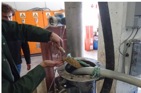
Figura 4.13 Imatge de l'addició de sediments al circuit, a través del dipòsit intermedi.
