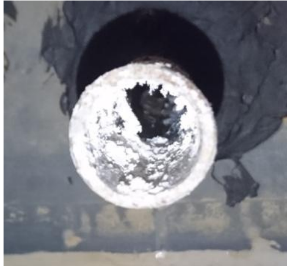
Figura 1.6 Cristallització de sal en les parets interiors del tub de \frac{3}{4} de polzada, mesos després de l'últim assaig realitzat i de la neteja del circuit.
