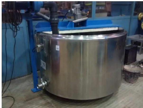
Figura 3.48 Tanc de refrigeració Hackman Wedholms.
