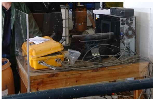
Figura 4.8 Punt de recepció de les dades, amb l'enregistrador de dades i l'ordinador que conté el software de lectura en temps real.
