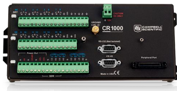
Figura 3.8 Enregistrador de dades Campbell, model CR1000, encarregat del registre de les lectures dels sensors instal·lats al llarg del circuit.
