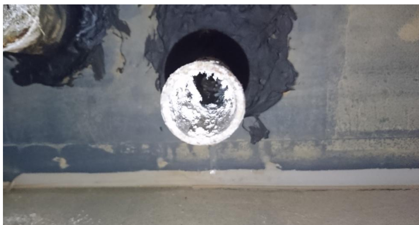
Figura 3.69 Cristallització de sal en les parets interiors del tub de \frac{3}{4} de polzada, mesos després de l'últim assaig realitzat i de la neteja del circuit.
