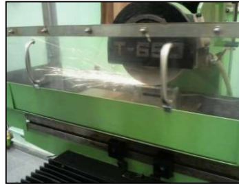
Figura 8. Generación de calor entre la pieza y la muela.
