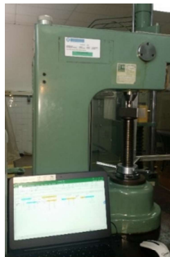
Figura 32. Medición de la dureza de las probetas.
