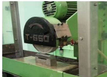
Figura 39. Máquina rectificadora plana utilizada es Modelo KAIR T650.
