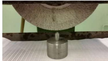
Figura 37. Disposición entre la muela y la herramienta de diamantado.
