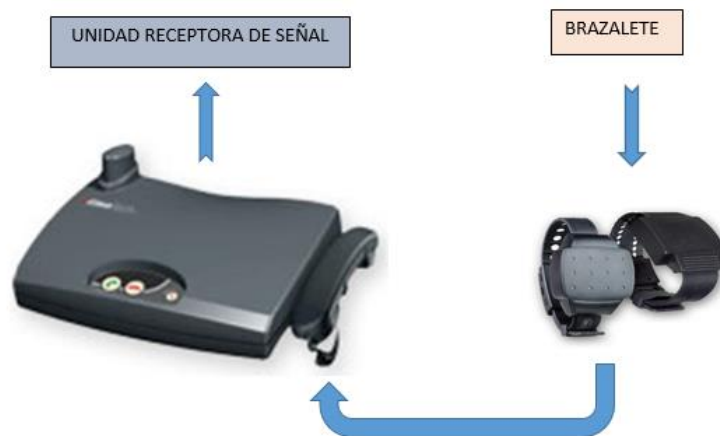
Figura 33. Unidad de recepción de señal y brazalete electrónico utilizado en Colombia. Fuente: Construcción propia con imágenes en línea.
