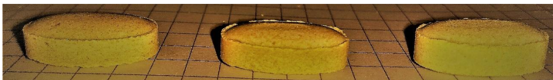
Il·lustració 37. Comprimits obtinguts per la Referència 3 (esquerra) i la Referència 6 (centre i dreta) a les dues forces compressió. Contrast augmentat per facilitar la identificació del defecte.
