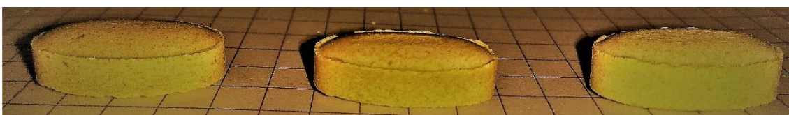
Il·lustració 93. Comprimits obtinguts per la referència 3 (esquerra) i la referència 6 (centre i dreta) a les dues forces compressió. Contrast augmentat per facilitar la identificació del defecte.
