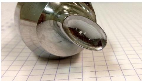
Il·lustració 91. Estat del punxó superior al finalitzar la compressió en mode automàtic de la referència 5
