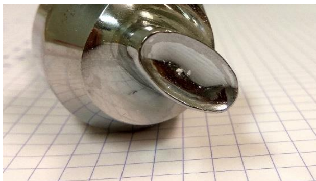
Il·lustració 35. Estat del punxó superior al finalitzar la compressió en mode automàtic de la referència 5.
