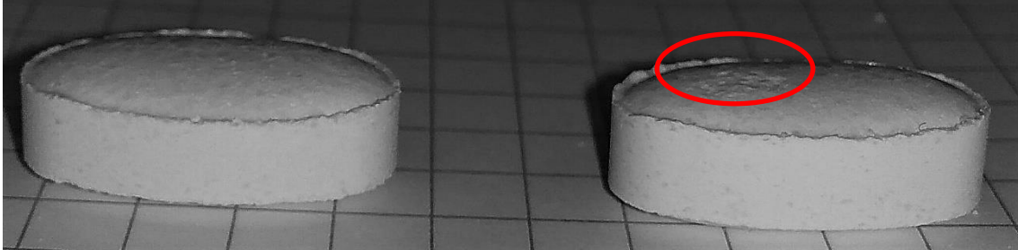
Il·lustració 34. Comprimits obtinguts per la referència 1 (esquerra) i la referència 4 (dreta), defecte a la superfície indicat amb un cercle vermell, fotografia en blanc i negre per augmentar el contrast.
