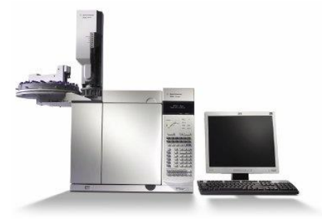
Figura 3.10 Cromatògraf de gasos acoblat amb detector de captura d'electrons (GC-ECD).
