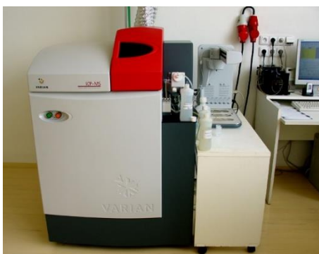
Figura 3.12 Espectrometria de Masses per Plasma d'Acoblament Inductiu (ICP-MS).
